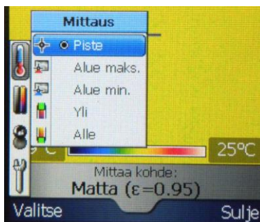
Kuva 6. Mittaus-valikko. Haluttu mittaustapa valitaan liikkumalla nuolinäppäimellä (ylös/alas) halutun mittaustavan kohdalle ja tämän jälkeen painamalla oikealle osoittavaa nuolinäppäintä.
