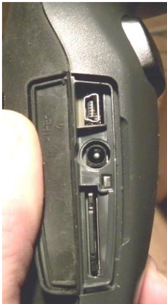
Kuva 3. USB-kaapelin ja latauspistokkeen kiinnityspaikat sekä muistikortti.
