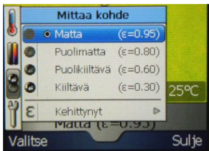
Kuva 8. Mittaa kohde-valikko. Tästä valikosta voi muuttaa emissiivisyyttä. Emissiivisyys tarkoittaa mitattavan kohteen lähettämän säteilyn määrä verrattuna täysin mustan kappaleen säteilyyn.
